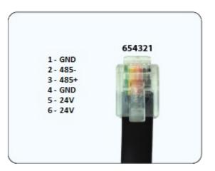
Figure 8. RJ12 pins
